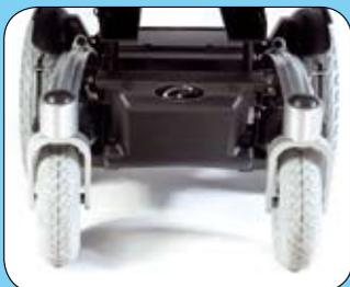
Base de reducidas dimensiones (sólo 28,5 cm de altura) con baterías de 60 Amps de serie
